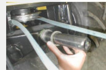
**3** – Monter la coupelle sur le tube de la cellule et le plaquer contre les rondelles.
